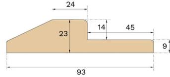
Diese Schwelle mit Falz wird aus FSC®-zertifiziertem Massivholz gefertigt und steht für nachhaltige Forstwirtschaft. Die Schwelle mit Falz sorgt für eine engere Verbindung zwischen der Tür und der Schwelle und ist ideal, wenn die geschlossene Tür eine gute Schalldämmung bieten soll.
