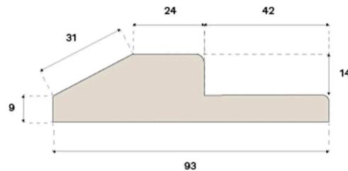
Diese lackierte, Schwelle mit Falz wird aus FSC®-zertifiziertem Massivholz gefertigt und steht für nachhaltige Forstwirtschaft. Die Schwelle mit Falz sorgt für eine engere Verbindung zwischen der Tür und der Schwelle und ist ideal, wenn die geschlossene Tür eine gute Schalldämmung bieten soll.
